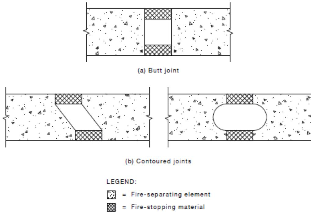
FIGURE 10.12.6 CONTOURED CONTROL JOINTS
